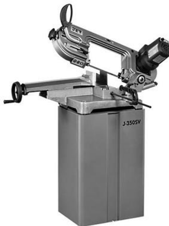
J-350CSV – напольная версия станка с системой СОЖ
