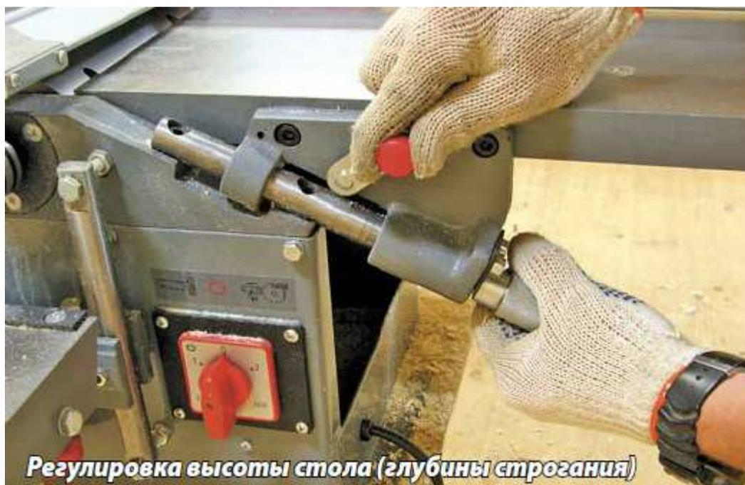
Глубину строгания за один проход регулируют, изменяя положение переднего стола. Как правило, во всех случаях принцип действия один — передний стол двигают по наклонным направляющим. Наилучший вариант — штанги, которые обеспечивают как точность (отсутствие перекосов), так и легкость (отсутствие подклиниваний) регулировки. Фиксатор стола зажимает направляющие с двух сторон.
