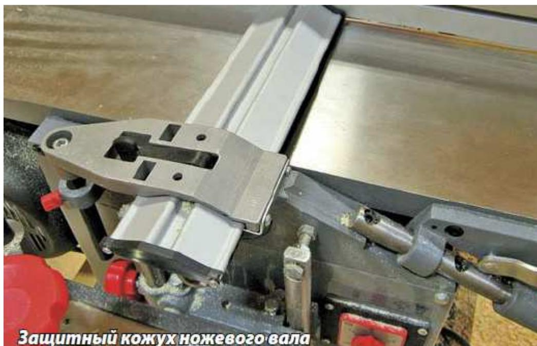
В целях безопасности производители комплектуют станки защитой. Планку сдвигают и фиксируют, оставляя открытой лишь ту часть барабана, которая задействована в работе.
