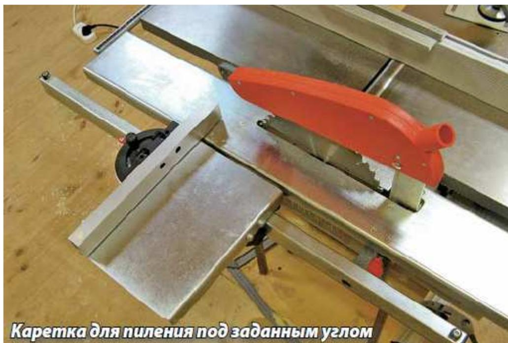
Очень удобное и полезное в работе приспособление — каретка. Если есть возможность, то пользоваться ею нужно при выполнении любых точных резов, а не только тех, что связаны с торцеванием. В зависимости от класса станка механизм, направляющий каретку, может быть разным. Например, длинный пруток и пара втулок. Лучше если вместо прутка мощный рельс, а вместо втулок ролики.
