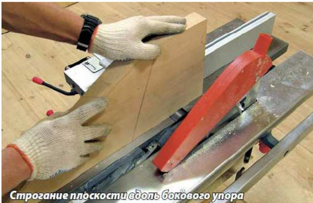
Еще одна популярная операция — строгание. Как правило, возможности универсальных станков ограничены фугованием, то есть выравниванием одной плоскости. «Станки-специалисты» (не универсальные, а просто строгальные) обычно имеют два стола и могут также производить рейсмусование. Важные параметры: частота вращения ножевого вала, длина столов, возможность точной настройки, максимальная глубина строгания.
