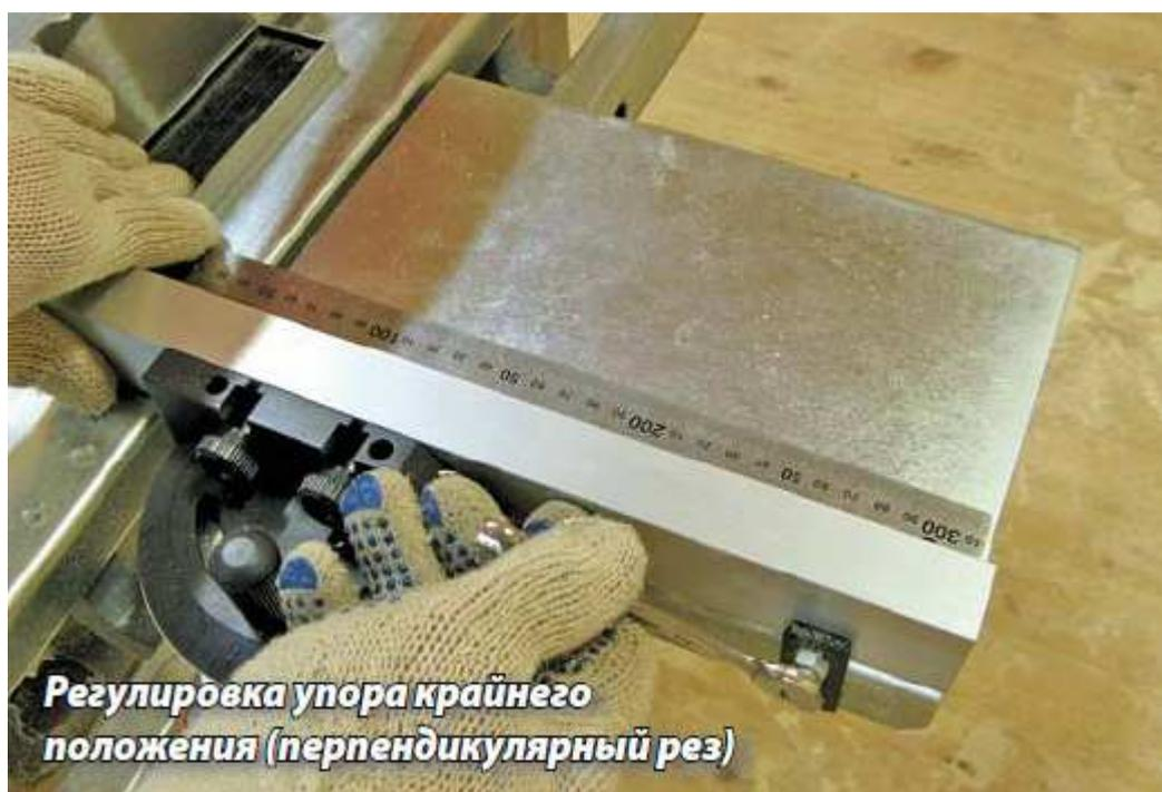
**Регулировка упора крайнего положения (перпендикулярный рез)**
