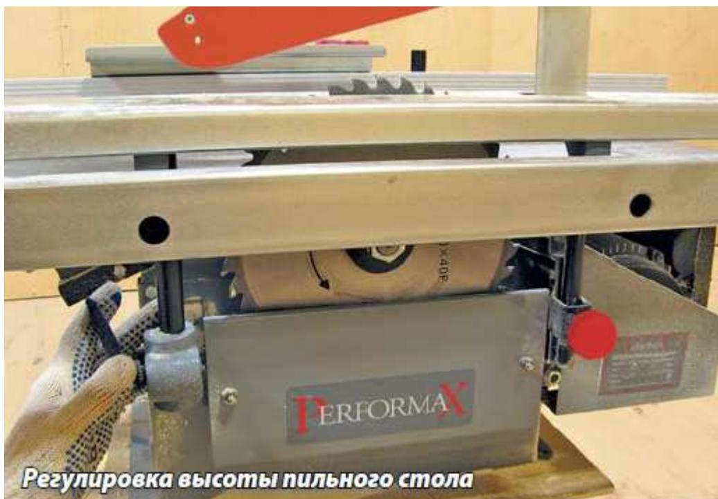
Если у специализированных пильных станков часто неподвижен стол, а положение меняет диск, то у универсалов все наоборот. В данном случае отдельный узкий пильный стол расположен на двух штангах (каждая из них с фиксатором). Достоинство: простота регулировки и отсутствие необходимости устранять перекосы после изменения высоты. Иногда пильный стол имеет большие размеры. В таком случае регулировать его сложнее, зато удобнее работать с крупными заготовками.
