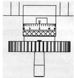
**ВАЖНО:** Если вы пропустили нулевые отметки, верните их обратно, по крайней мере, на пол-оборота, затем медленно совместите отметки обратно. Всегда, когда вы используете шкалу, как индикатор, чтобы продвинуть поперечные салазки или резцовые салазки крестового суппорта, ВСЕГДА используйте эту процедуру, чтобы выровнять отметки. Обязательно принимайте это во внимание.
