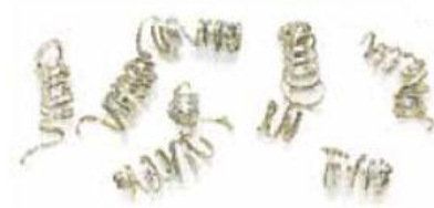
Свободно намотанная (витая) стружка идеальные условия резания
